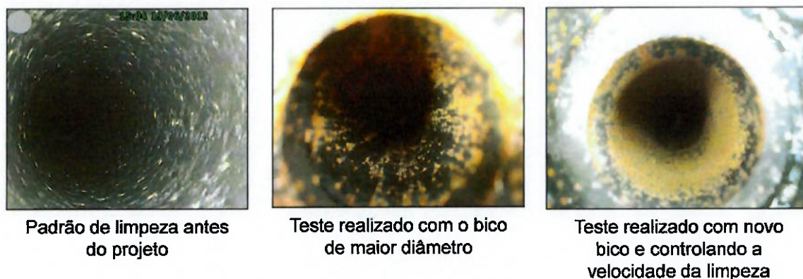
Figura 25: Progresso na limpeza da parede interna do tubo do TLE
