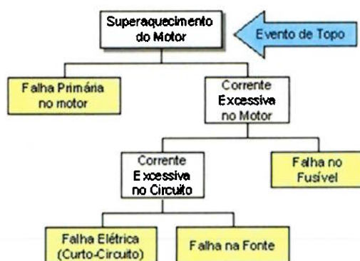
Figura 14: Exemplo de construção de uma Árvore de Falha
