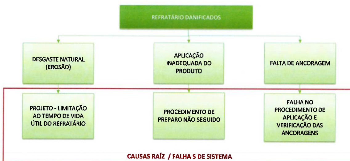
Figura 22: Árvore de Falhas para a causa “Refratário dos cones e saias danificados”
