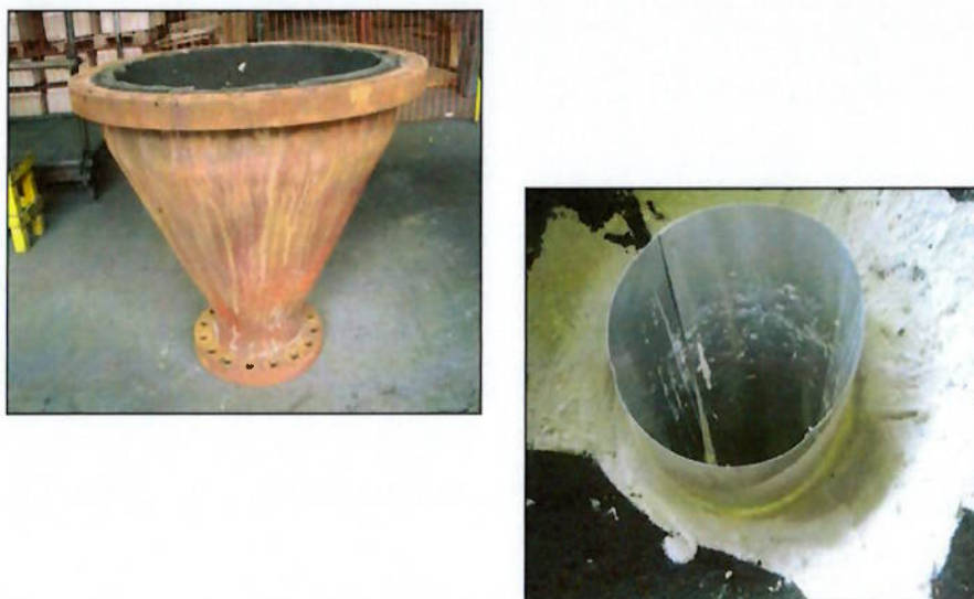
Figura 26: Cone do TLE e acompanhamento da aplicação do refratário ao cone
